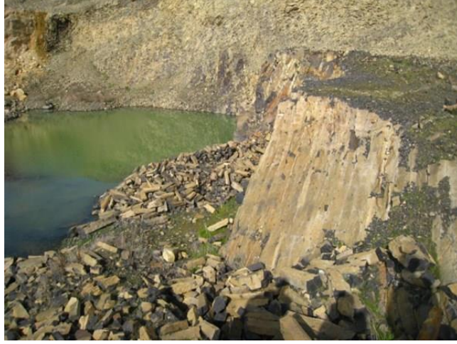
Şekil 5.12 Bazalt agregası ocak kesidi, önde şu anda çalışılan saha, arkada geçmişte çalışılan kısım.
