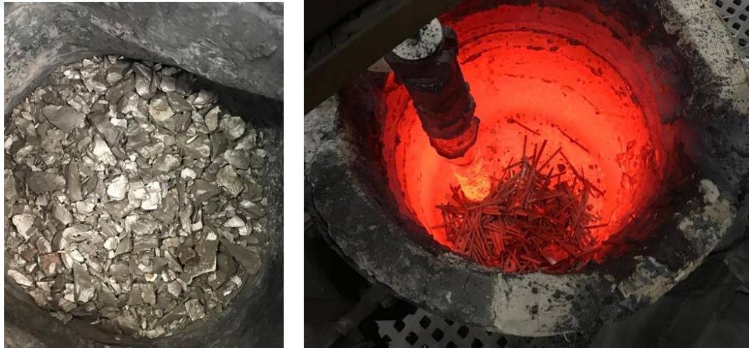
Şekil 3.3. Deneyisel çalışmalarda kullanılan Fe-Ti alyajları ve potada aşılama yöntemi
