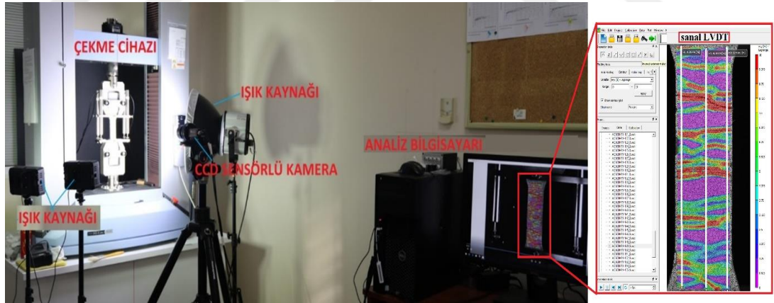
Şekil 3.7. Çekme deneyi cihazı ve görüntü analiz ekipmanları (Kişisel arşiv, 2016)
