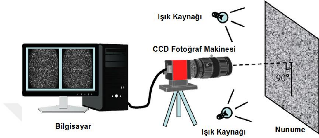
Şekil 2.10 Beneklenmiş görüntü elde etmek için tipik DIC sistemi (Liu ve diğer., 2015)
