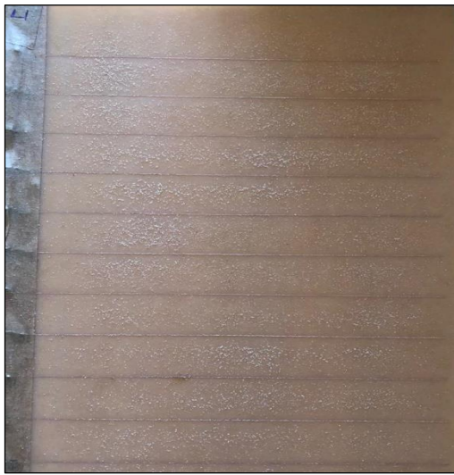
Şekil 4.19. L1 kodlu plaket tozların bakır yollar arasında toplanmış hali
