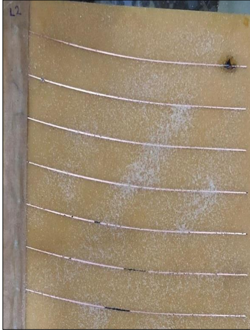
Şekil 4.21. L2 kodlu 4 kanal 1Hz 11kV tozlu plakette
