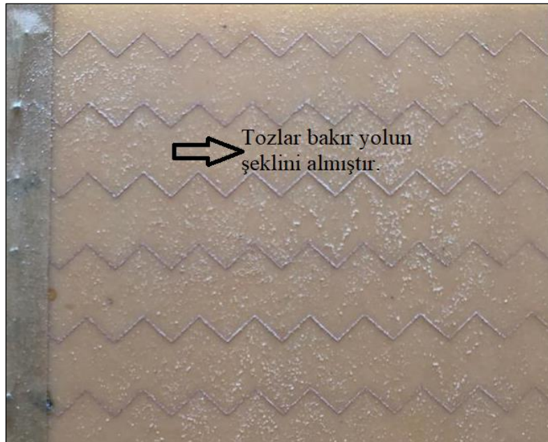
Şekil 4.14. M4 kodlu plaket tozların bakır yollar arasında toplanmış hali
