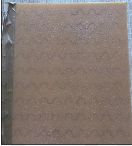
Şekil 4.11. M3 kodlu plaket 100-300 µm homojen tozlu hali
