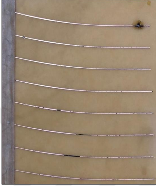
Şekil 4.20. L2 kodlu 4 kanal 1Hz 11kV temiz plakette
