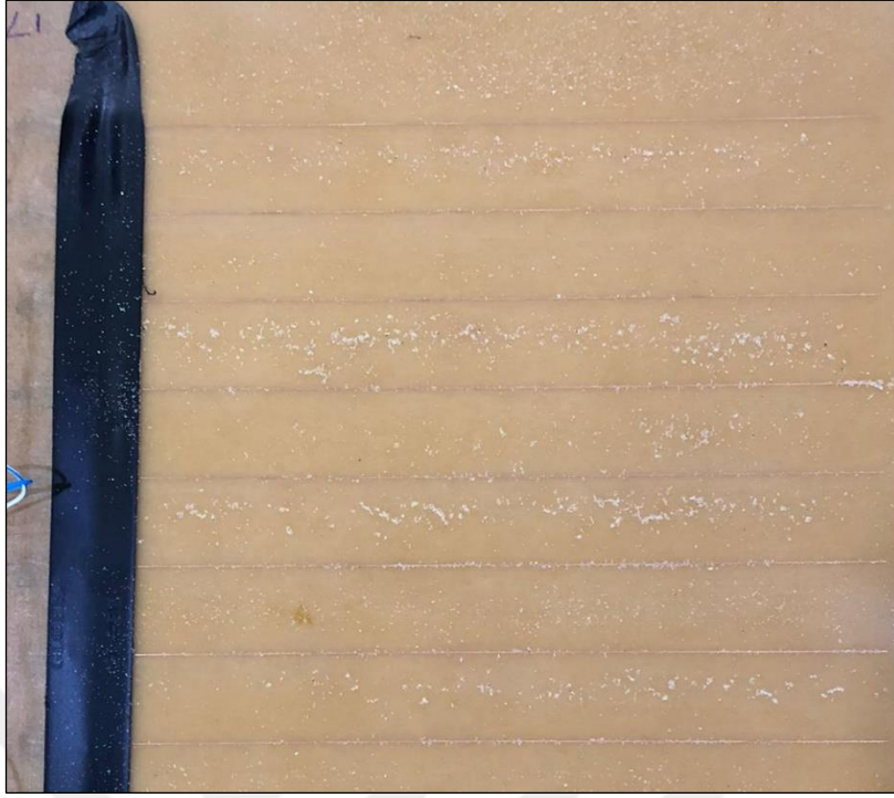
Şekil 4.24. L1 1Hz 11kV 4 kanal plaket tozların bakır yollar arasında toplanmış hali
