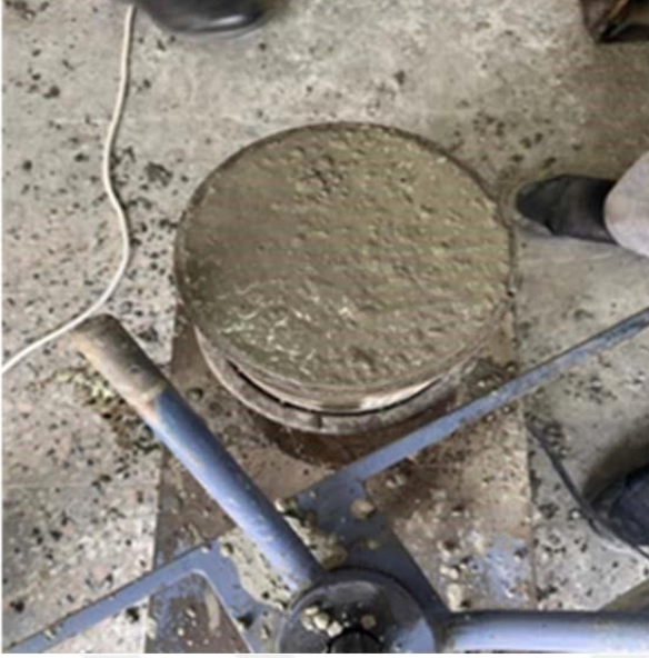
Şekil 3.5. Basınç dayanımı tayini için silindirik numune alımı: (a) çelik lifsiz ve (b) çelik lifli beton
