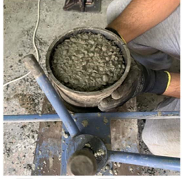
Şekil 3.5. Basınç dayanımı tayini için silindirik numune alımı: (a) çelik lifsiz ve (b) çelik lifli beton
