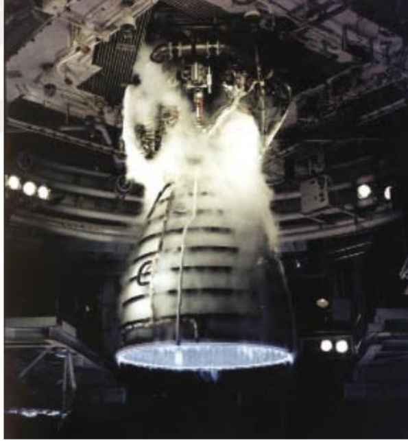
Şekil 2.9. Rocketdyne tarafından yapılan bir uzay mekiği ana motoru (NASA Technical Anonymous, 2011)
