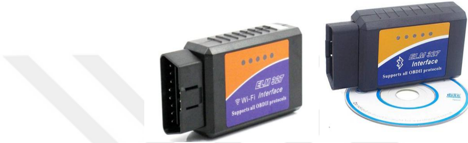
Şekil 3.15. Wi-Fi ve bluetooth'lu ELM 327 diyagnostik cihazı
