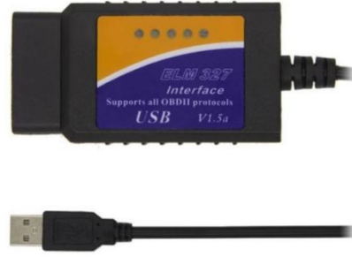
Şekil 3.14. USB girişli ELM 327 diyagnostik cihazı
