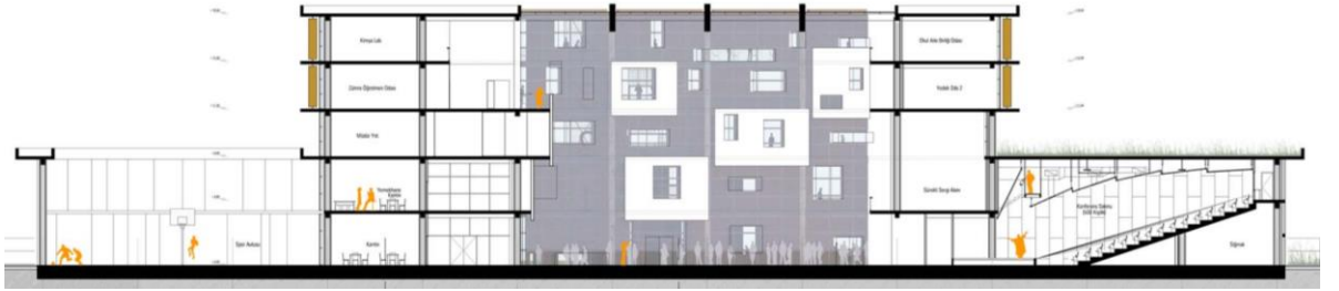
Şekil 4.133. Özel İAOSB Nedim Uysal MTAL Lisesi galeride cam tavanı gösteren kesit (URL-50).
