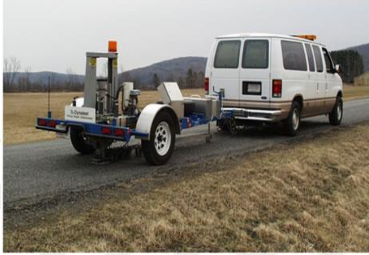
Resim 2.2 Dynatest model düşen ağırlıklı deflektometre cihazı (İnt.Kyn.4)
