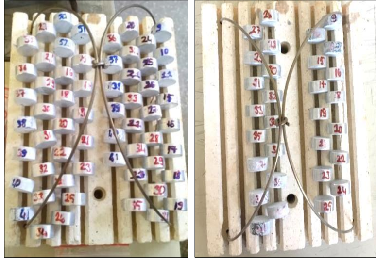
Şekil 3. 5. Sinterleme öncesi numuneler
