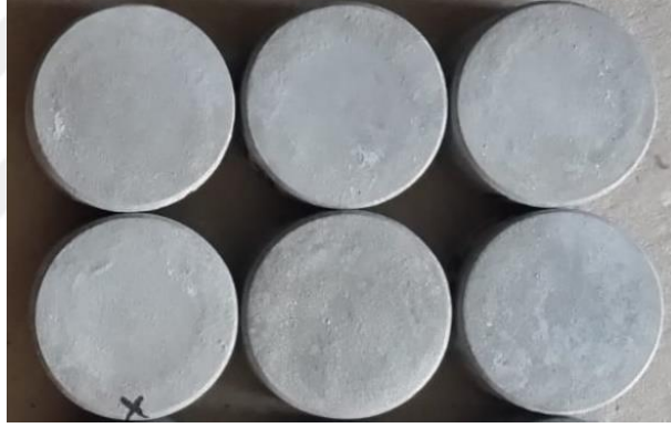
Şekil 4. 6. İki kez daldırma iki kez sinterleme ile ardışık kaplanmış numunelerin kaplama yapılarını gösteren fotoğrafları a) A2-S2, b) B2-S2, c) C2-S2
