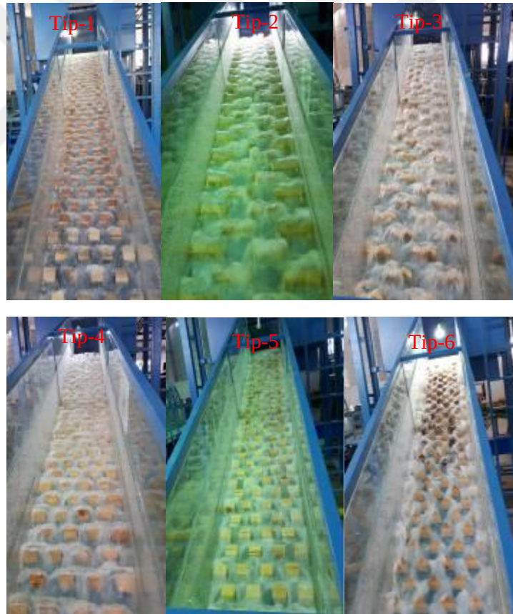
Şekil 4.2 : \alpha=20^\circ açı ve Fr= 0.64 için kanal içindeki akım durumları.
