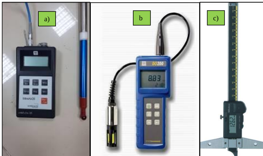
Şekil 3.15 : a) Akım hızı ölçer b) YSI Model DO 200 oksijenmetre c) Dijital limnimetre.
