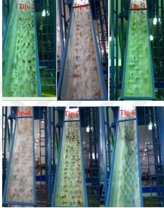
Şekil 4.6 : \alpha=56^\circ açı ve Fr=0.64 için kanal içindeki akım durumları.
