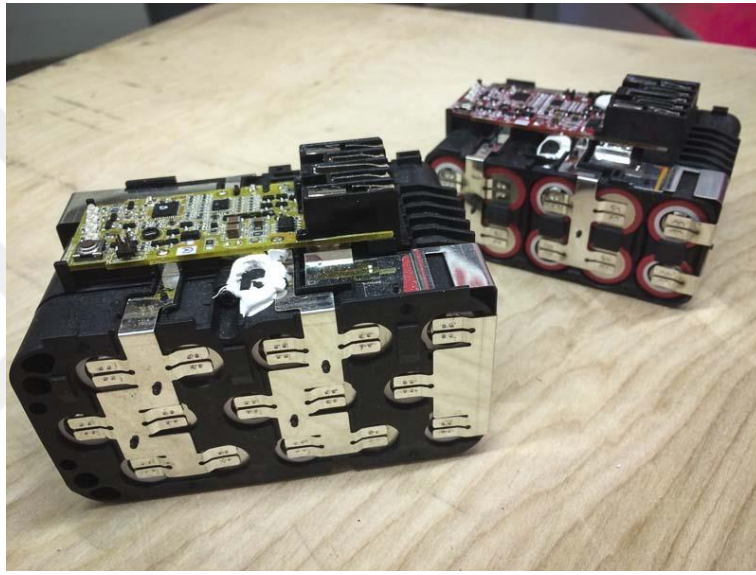
Şekil 2.4 : Lityum iyon batarya paketi ve entegre haldeki batarya yönetim sistemi (Löbberding ve diğ, 2020).
