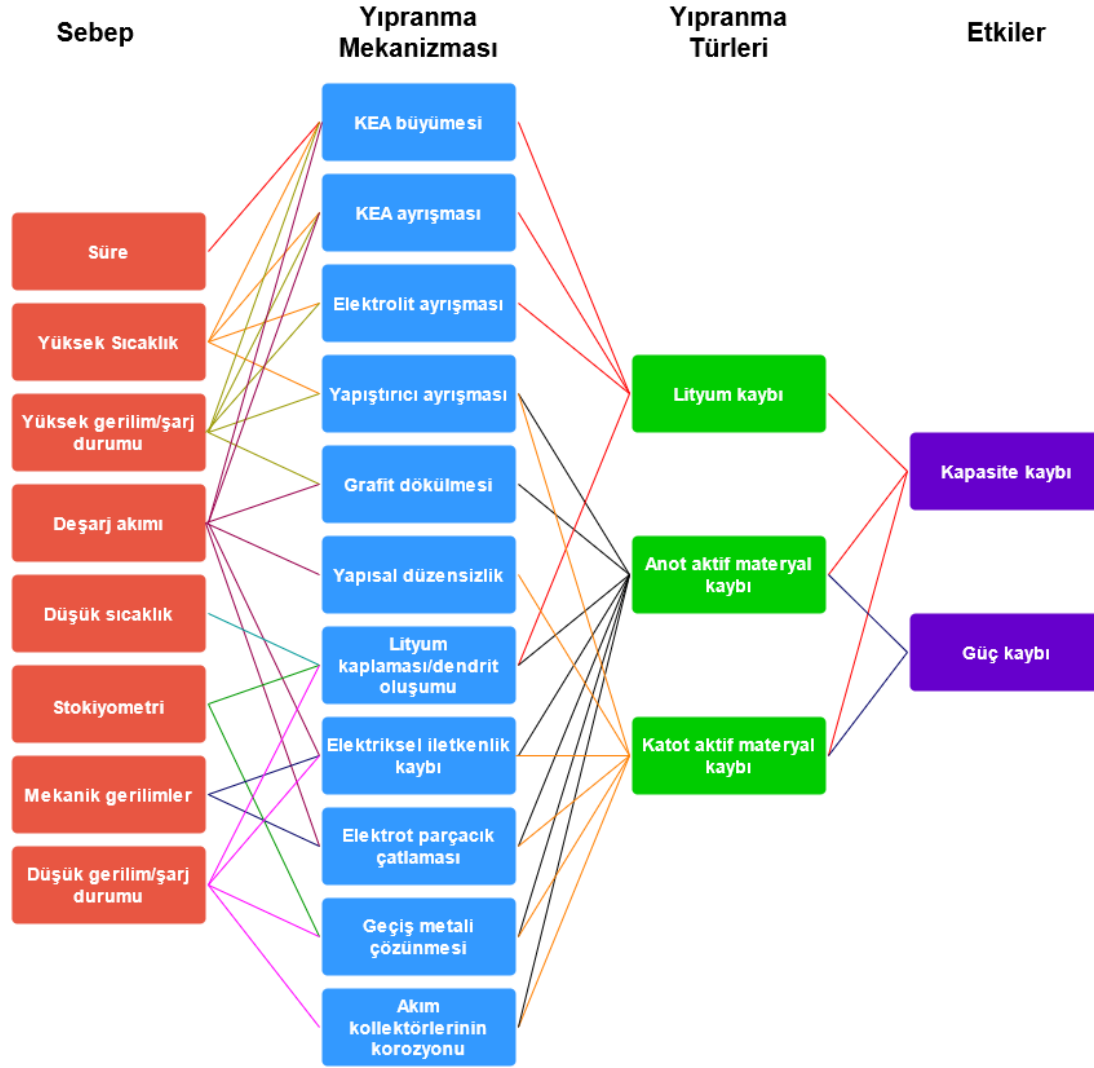
Şekil 2.7 : Bozulma mekanizması ile ilgili sebep sonuç bağlantıları (Birkel ve diğ., 2017).
