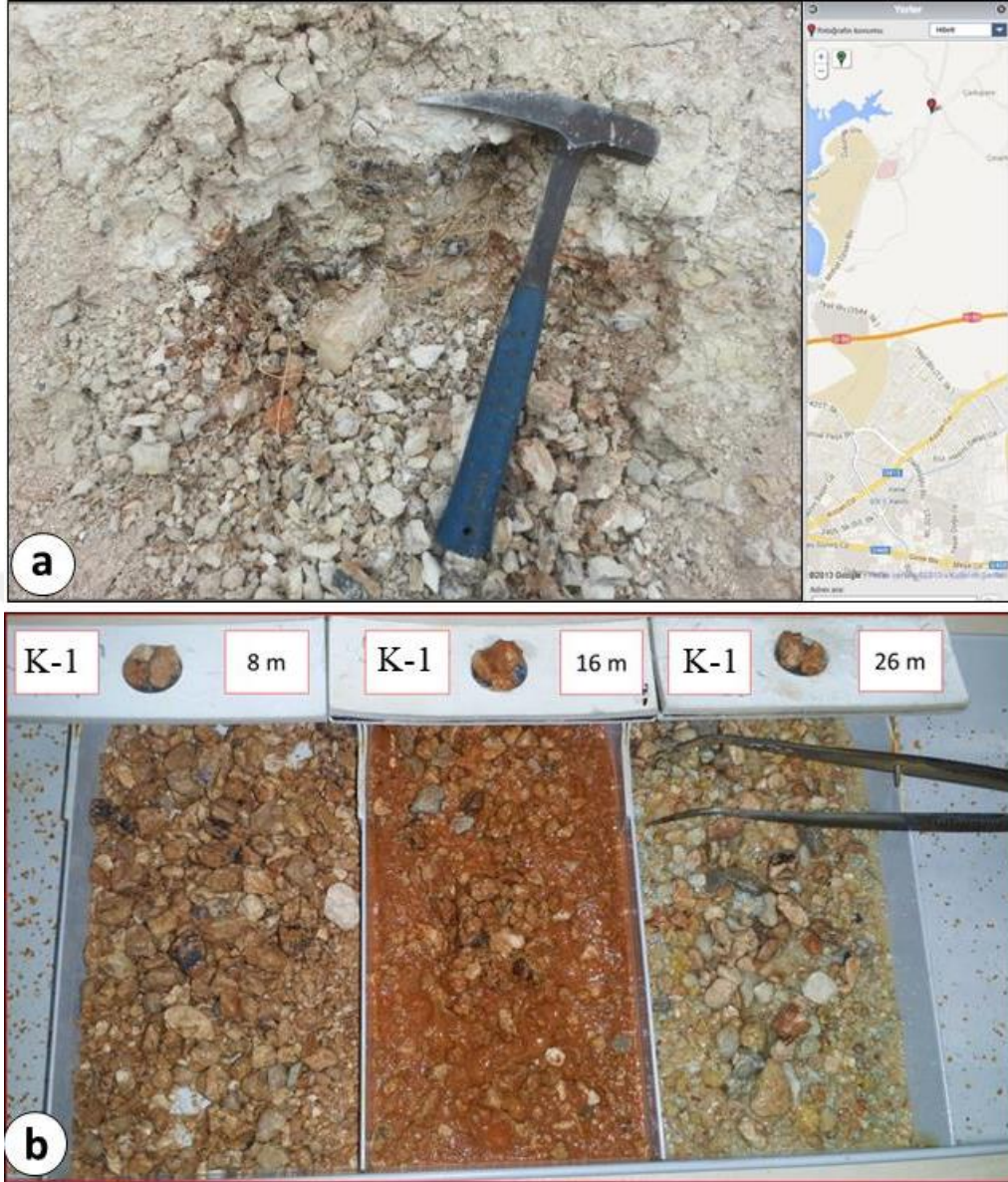
Şekil 3.7 Bölgedeki kalış çökelleri; a) Arazide gözlenen kalışlar b) Adana kara alanında açılan K-1 sondaj kesintilerinden kalış örnekleri
