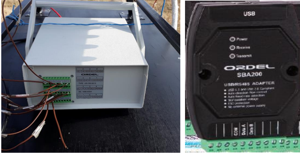
Resim 3.13. Deneylerde kullanılan Usb dönüştürücü ve Datalogger
