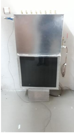
Resim 3.7. Kollektörün tamamen yalıtılıp camla kapatıldıktan sonraki hali
