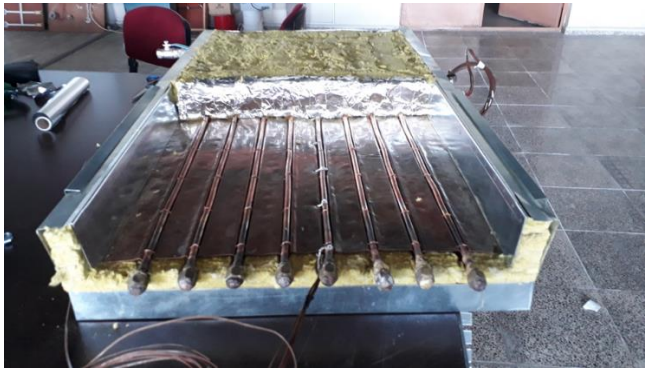
Resim 3.6. Depo ve kollektörün ısı yalıtımı
