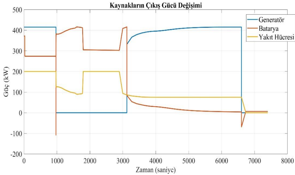
Şekil 6.45: Senaryo 5 ve uzun uçuş için kaynakların çıkış gücü değişimi.
