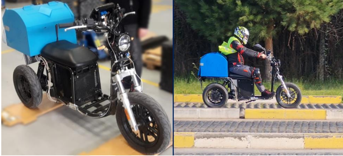
Şekil 6.15: Yol testi için enstrümante edilmiş prototip araç ve yol testi görselleri.
