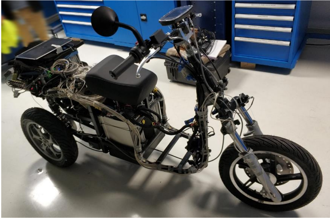
Şekil 5.10: Yol testi için enstrümantasyonu tamamlanmış ilk deneme aracı.
