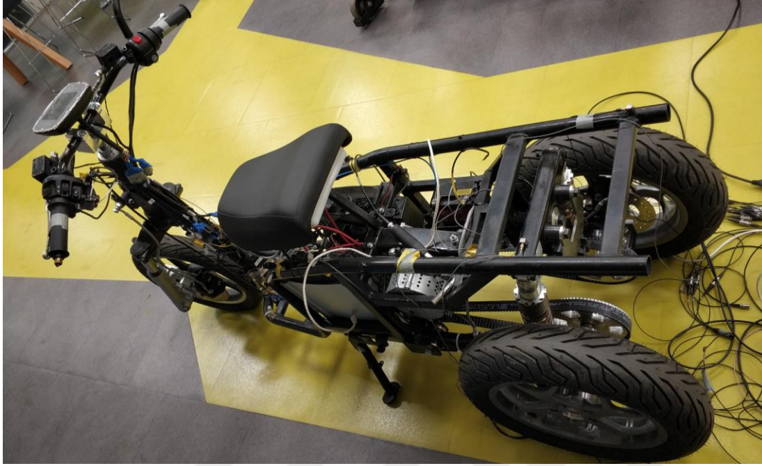
Şekil 5.17: Enstrümante edilmiş, modal teste hazır deneme aracı.
