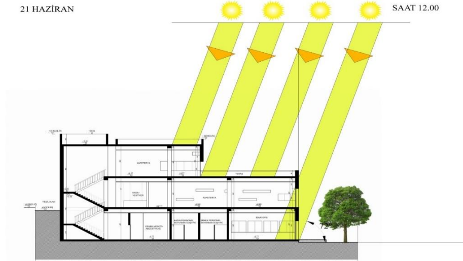
Şekil 4.17 21 Haziran, Yapının Kesiti Üzerinden Güneşlenme Durumu
