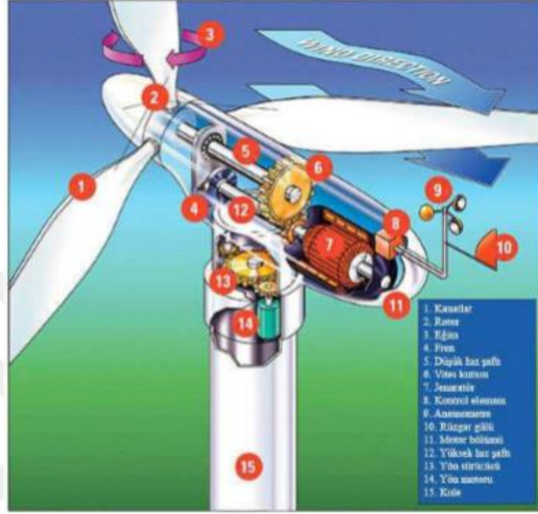
Şekil 20: Rüzgâr Santralinde Yatay Eksenli Türbin ve Türbini Oluşturan Unsurlar
