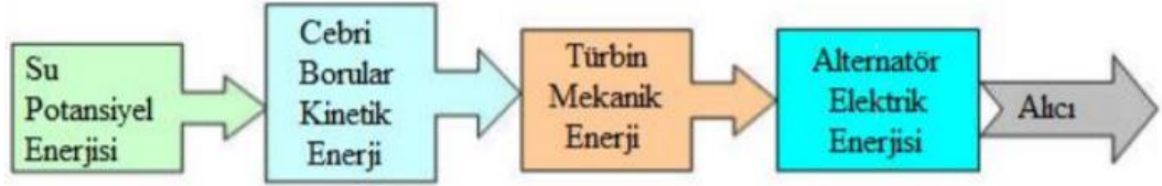
Şekil 17: Hidroelektrik Üretim Akım Şeması
