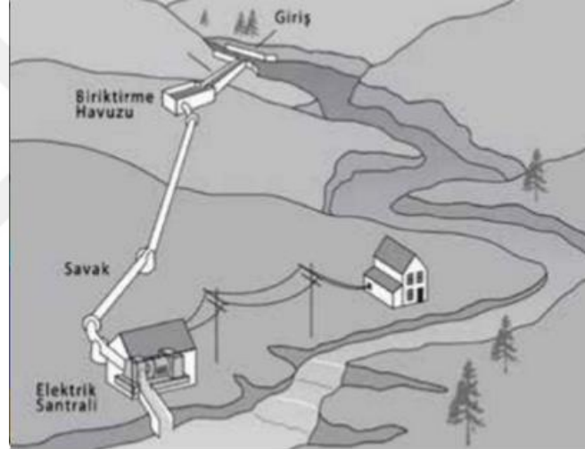
Şekil 19: Akarsu Tipi Hidroelektrik Santrali
