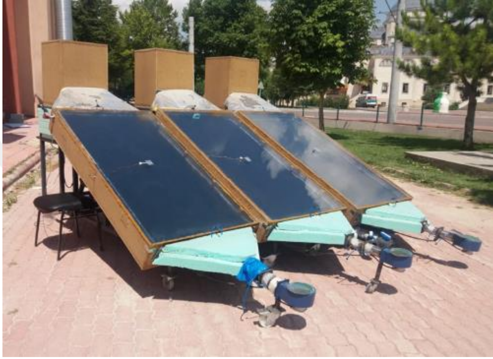
Şekil 4.2. Düzlemsel bir güneş kolektörleri (Altunsoy, 2019).
