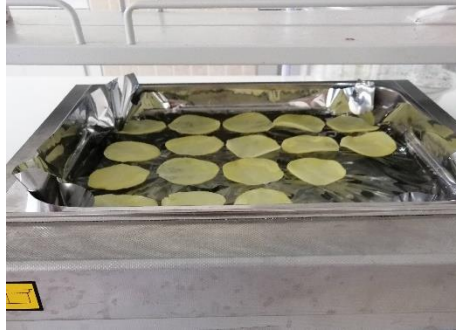
Şekil 3.2 Kırınım pencereleli kurutma yöntemi ile ön kurutma işlemi
