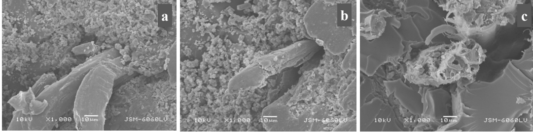
Şekil 6.35 : a.0BIO, b.0BIO-90, c.0BIO-120 numunelerinin SEM görselleri (büyütme oranı 1000x).
