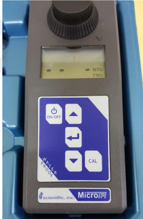
Görsel 3.9. Analizler için kullanılan türbidimetre cihazı
