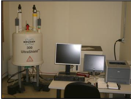
Resim 3.3. 300 MHz işletim frekanslı sıvı Bruker 300 MHz AV model NMR spektrometresi
