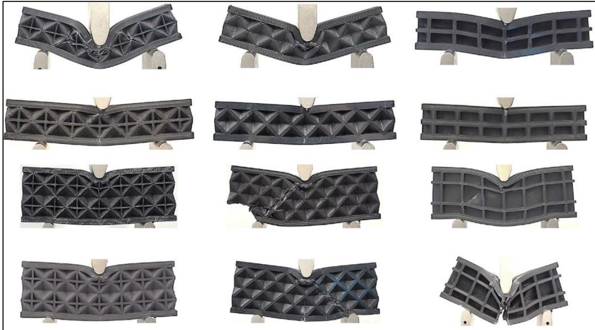
Şekil 4.54. Üç nokta eğme deneyinde numunelerin kırılma davranışları [177]
