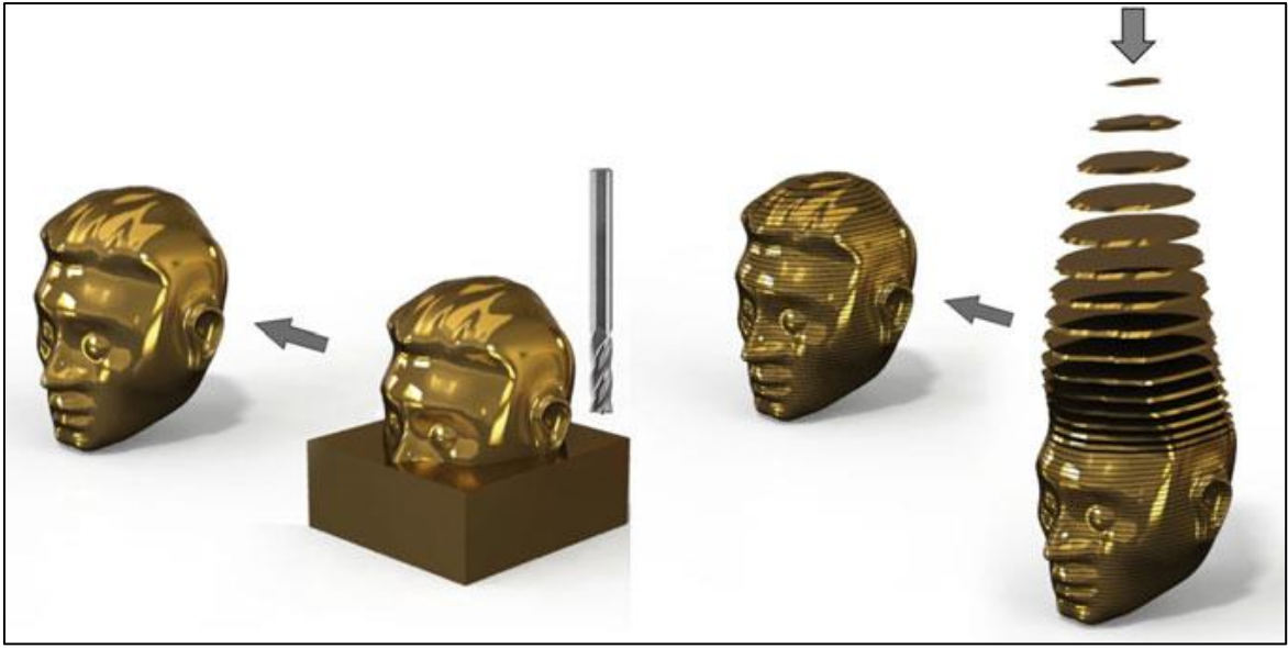
Şekil 2.1. Malzeme çıkarılarak yapılan geleneksel imalat ve malzeme eklenerek yapılan eklemeli imalat [1]
