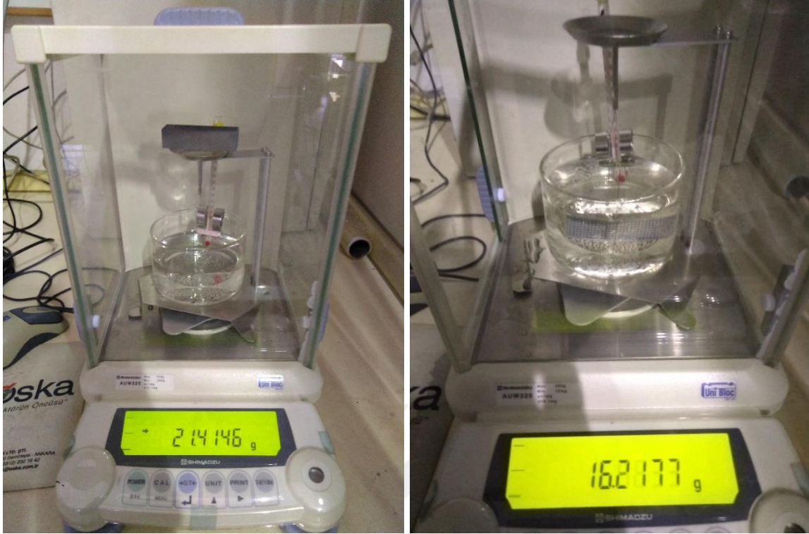
Resim 3.10. Numunenin havada ve suda tartılması
