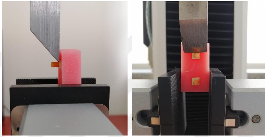
Şekil 3.16. Makaslama kuvvetinin uygulanması
