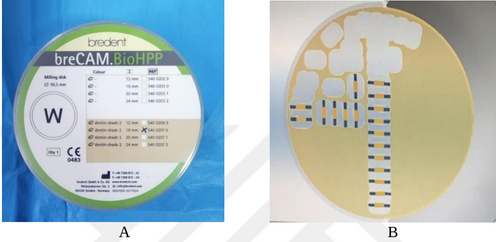
Şekil 3.1. A. Çalışmada kullanılan PEEK blok, B. PEEK örneklerin tasarımı
