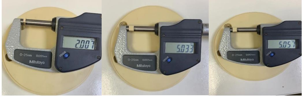
Şekil 3.3. PEEK örneklerin boyutları
