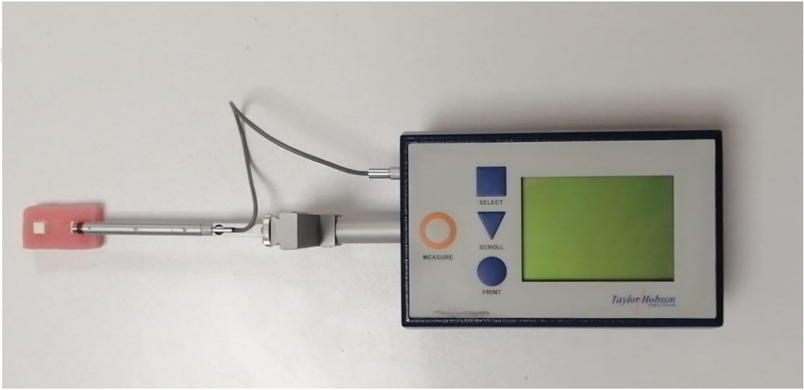
Şekil 3.11. PEEK örneklerin yüzey pürüzlülüğünün ölçümü
