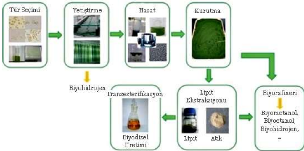
Şekil 2.22. Mikroalgal biyoyakıt üretimi için genel proses akışı (Mata vd. 2010; Singh ve Cu 2010)
