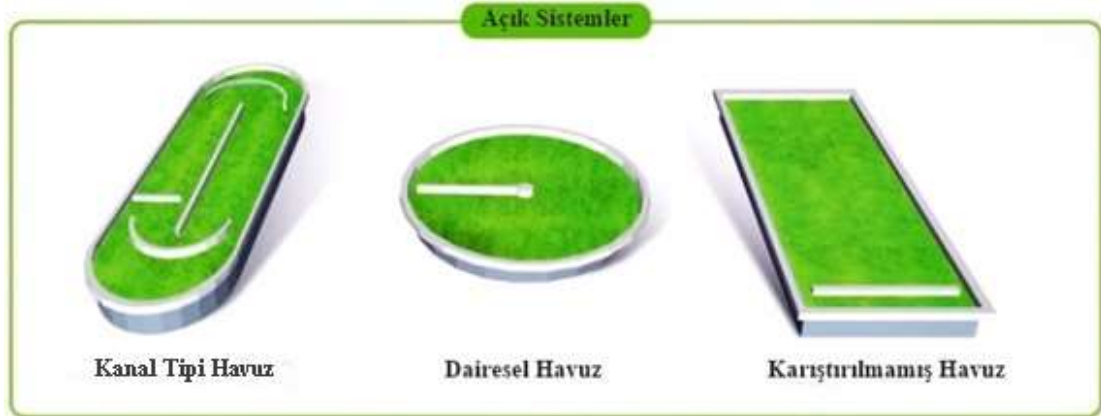
Şekil 2.17. Açık Sistemler (Zerrouki ve Henni 2019)
