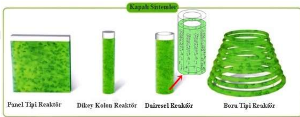
Şekil 2.18. Kapalı Sistemler (Zerrouki ve Henni 2019)
