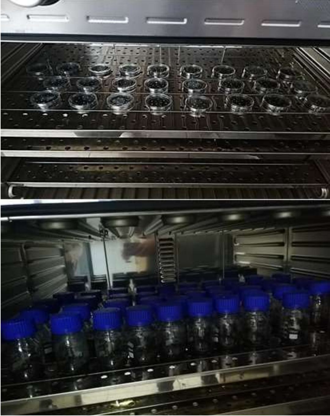
Şekil 3.13. Anterlere Etüvde 35 °C ve Karanlık Koşullarda Sıcaklık Şoku Uygulaması
