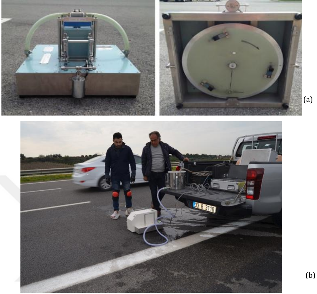
Şekil 3.13. Dinamik sürtünme ölçer (a) ve saha uygulaması (b)
