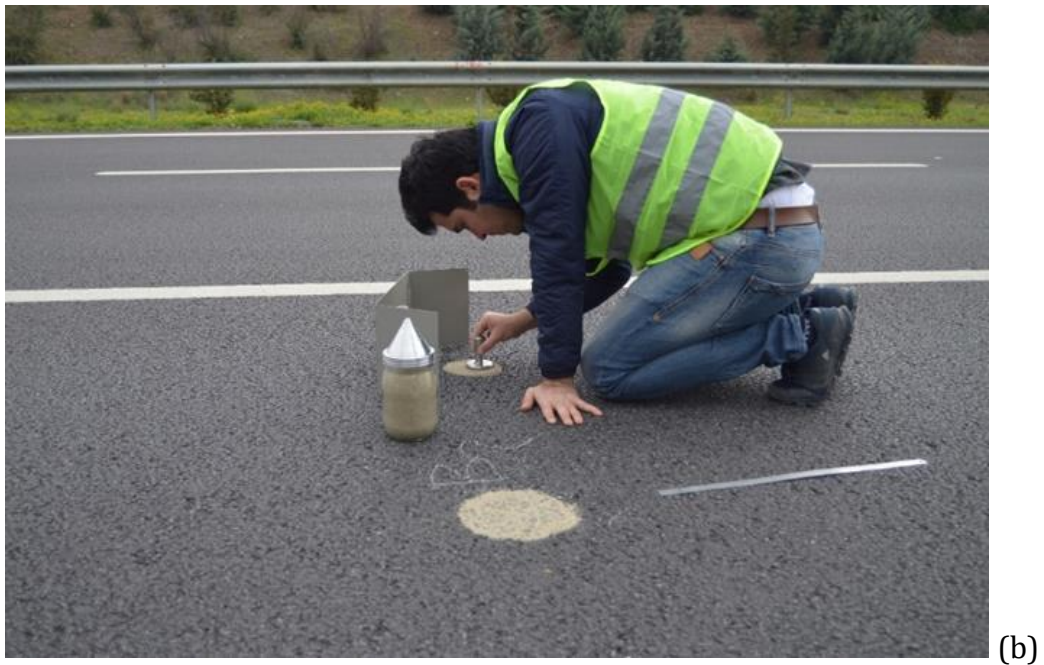
Şekil 3.16. Kum-yama testi şeması (a) ve sahada uygulaması (b)
