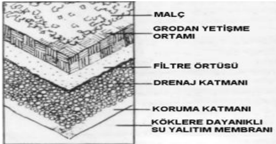
Şekil 3.22: Grodan İle Oluşturulan Bir Çatı Bahçesi Detayı
