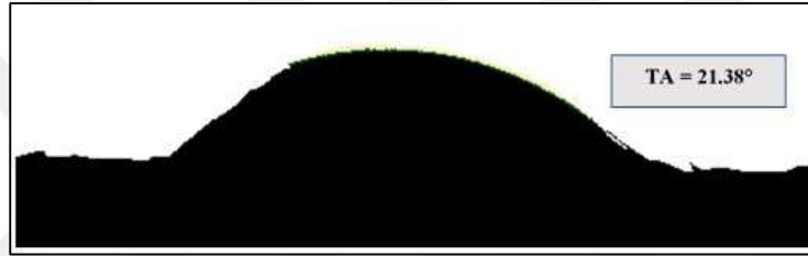
Şekil 8.1 İşlem görmemiş kumaş yüzeyinde su damlacık görüntüsü
