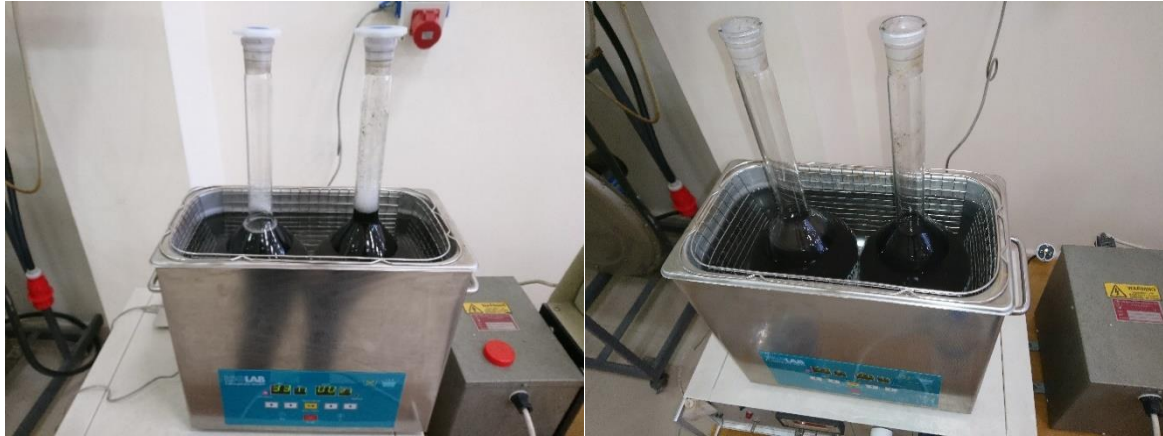
Resim 6.1. Ultrasonik banyoda tutulan hibrit nano akışkan
