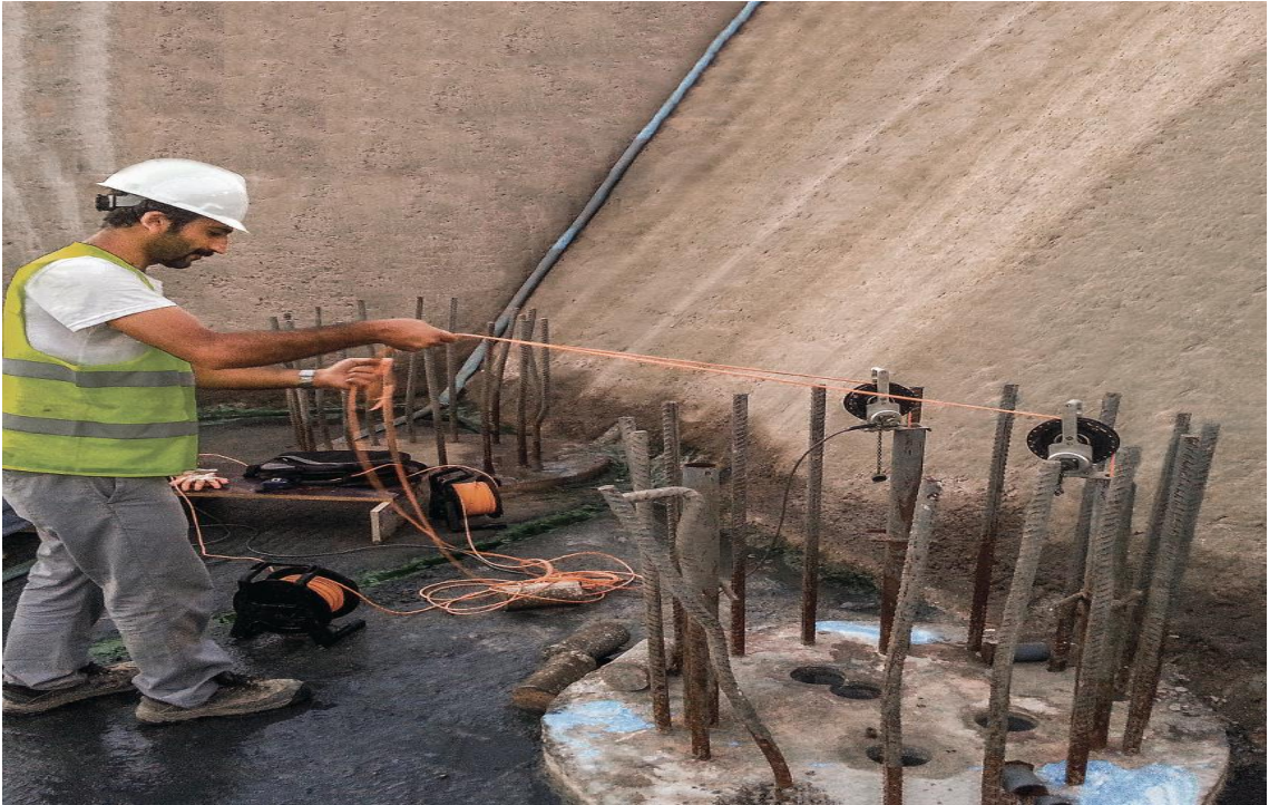
Resim 3.10 Çapraz sonik süreklilik testi.
