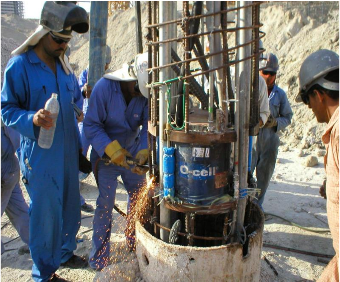
Resim 3.4 Osterberg deney yapılışı.
