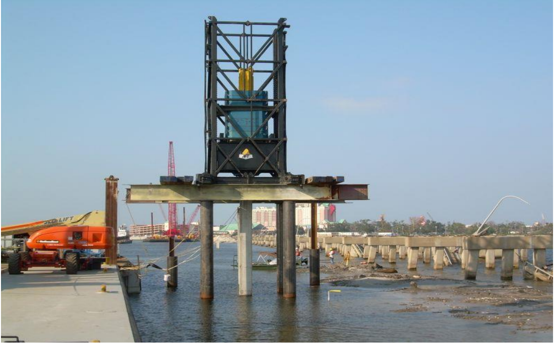
Resim 3.5 Statnamic deney yapılışı.
