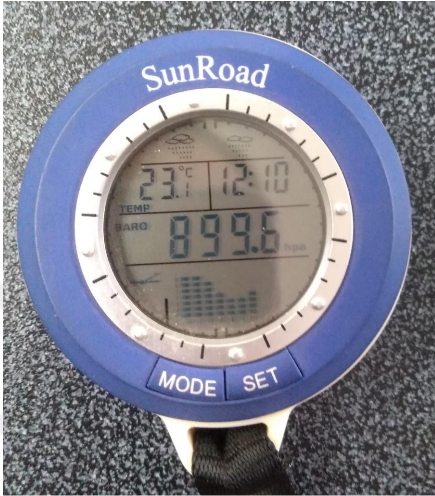
Şekil 4.4. Deneylerin yapıldığı ortam basıncının barometre ile ölçülmesi.
