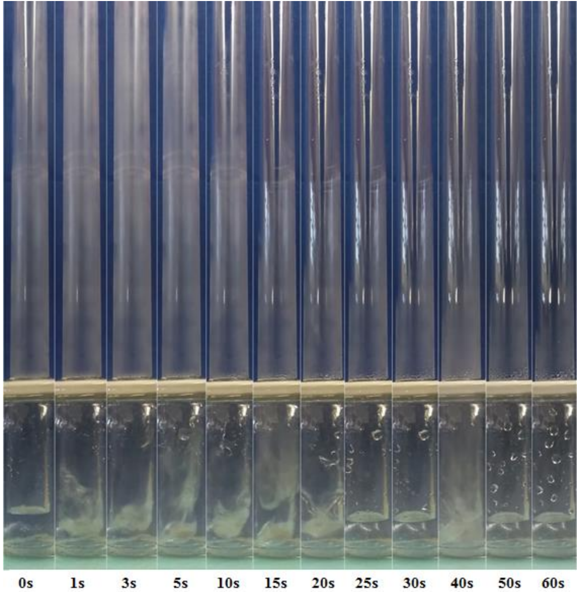
Şekil 6.54. Vakumlu cam borunun sıvı bölgesindeki farklı zaman adımları için buhar hacminin değişimi.
