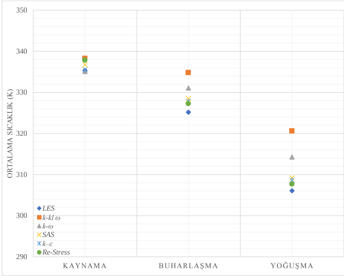
Şekil 6.79. 10ml sıvı içeren vakumlu cam borudaki T_{kay,ort} , T_{buh,ort} ve T_{yoğ,ort} değerlerinin farklı türbülans modellerine göre değişimi.
