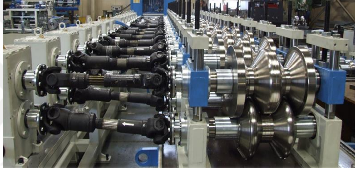
Şekil 2.7. Ağır seri kasetli tip roll form makinası [22].
