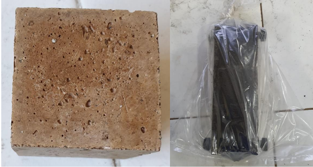
Şekil 30. Sertleşmiş haldeki geopolimer beton numunesi ve etüve konulmak üzere hazırlanmış poşetli numune.
