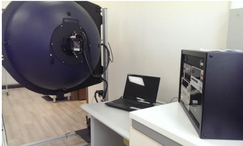
Şekil 2.10 : Sıcaklık kontrollü, 1m çaplı Ulbricht küresi.
