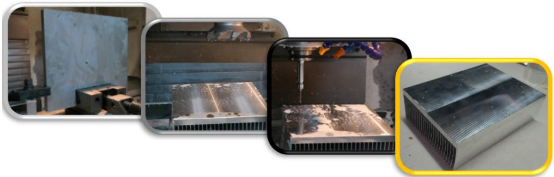
Şekil 4.12 : Alüminyum bloğun işlenmesi.
