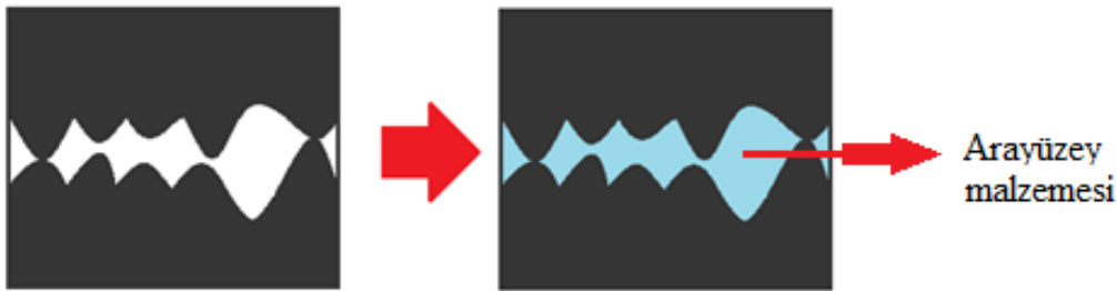
Şekil 4.4 : İki malzemenin birleşim bölgesindeki boşlukların ısıl ara yüzey malzemesi ile doldurulması.
