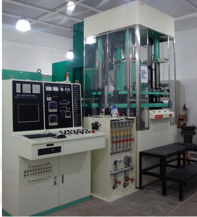
Şekil 3.7 : Dr. Sinter (7.40MK-VII,SPS Syntex Inc.) SPS cihazı.
