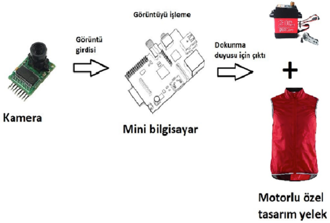
Şekil 3.1. Yapay Görme Sisteminin şematik yapısı
