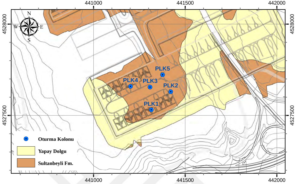
Şekil 4.79: Deneme dolgusu yapılan alan ve oturma miktarı ölçüm lokasyonları.
