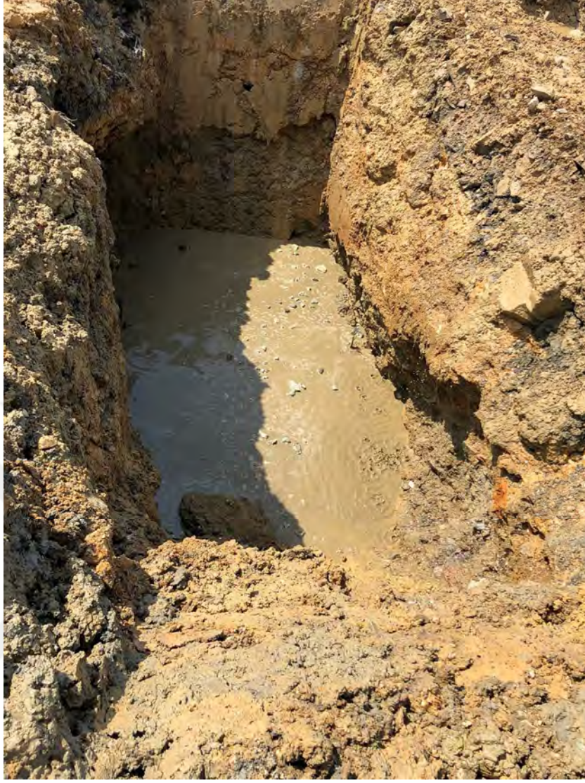
Şekil 4.46: Yeraltı suyunun yüzeye yakın bulunduğu araştırma çukurundan bir görünüm.
