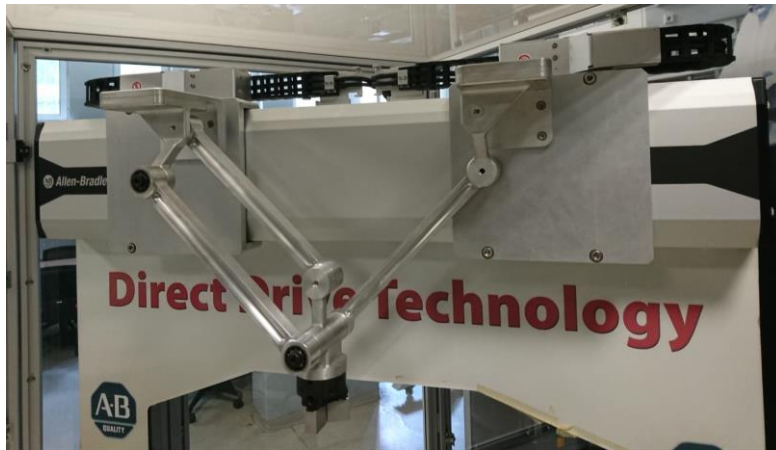
Şekil 5.3 : Z ekseninde hareket sağlayan lineer motorlar ve mekanizma.
