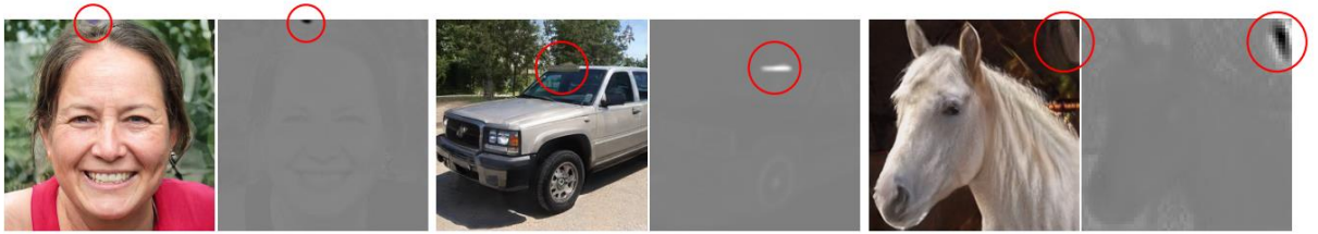
Şekil 3.12. AdaIN normalizasyonu sonucu imgelerde oluşan su damlacıkları kalıntıları. Damlacıklar, oluşturulan imgelerde tam olarak belli olmasa da üretici içindeki aktivasyon katmanlarında net olarak görülmektedir.
