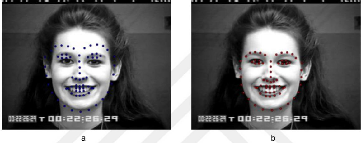
Şekil 4.3. AGM kullanılarak uydurulan 68 adet yüz özellik noktası. a. Uydurma öncesi 68 adet yüz özellik noktasının yüz üzerindeki konumu b. Uydurma sonrası 68 adet yüz özellik noktasının yüz üzerindeki konumu. Özellik noktaları yüz anahtar öğelerini çevrelemektedir.
