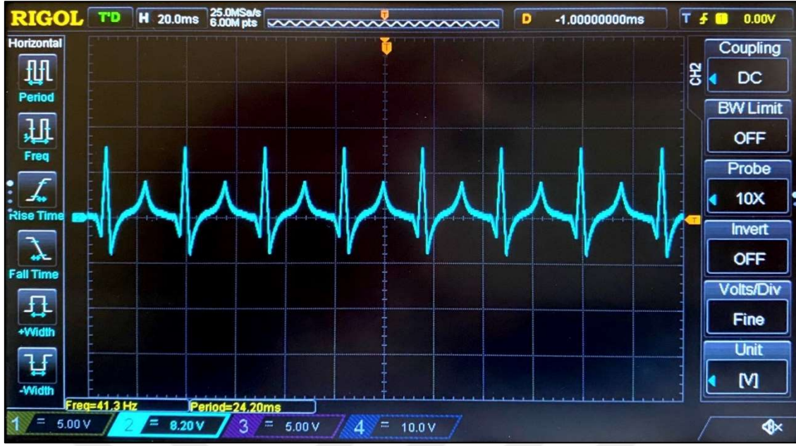
Şekil 4.17 SVT sinyaline ait osiloskop sonucu.
