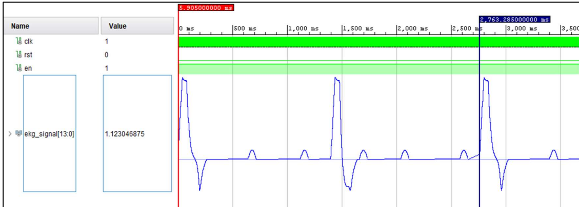
Şekil 4.52 Üçüncü derece AV Blok sinyaline ait Vivado Simülasyon sonuçları.
