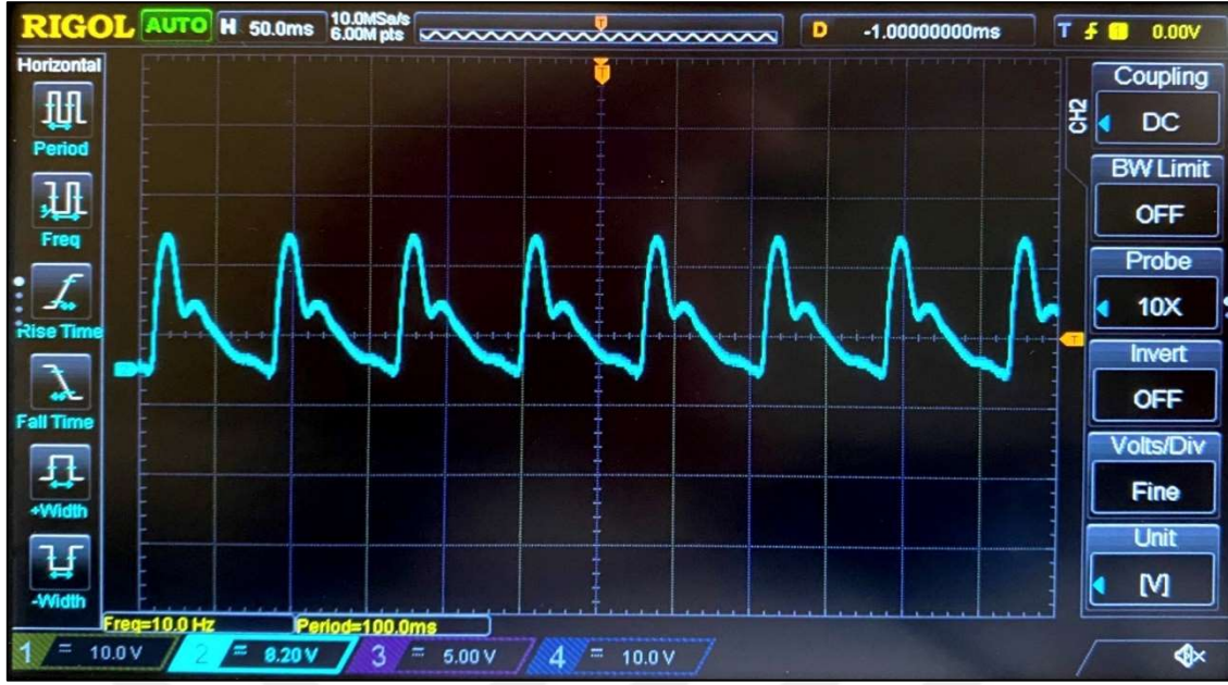
Şekil 4.32 NIBP sinyaline ait osiloskop sonucu.
