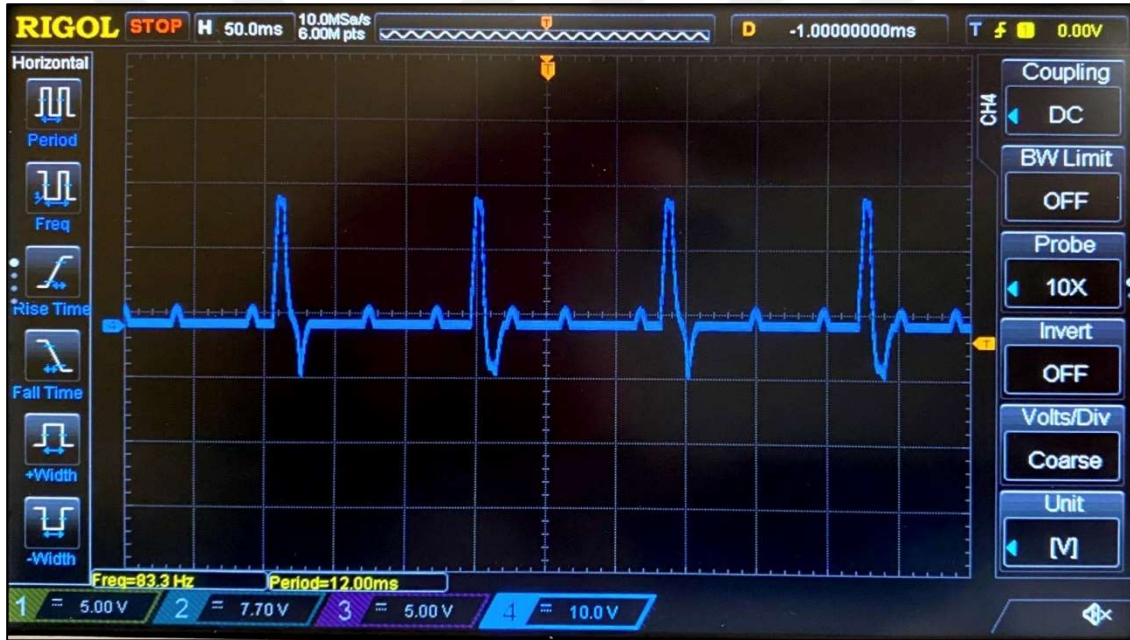
Şekil 4.53 Üçüncü derece AV Blok sinyaline ait osiloskop sonucu.
