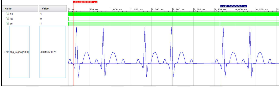
Şekil 4.49 İkinci derece AV Blok Tip-2 sinyaline ait Vivado Simülasyon sonuçları.
