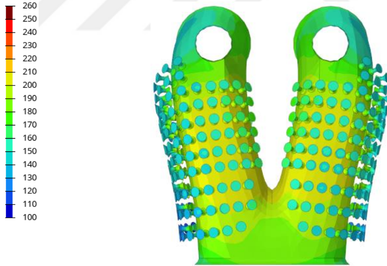
Şekil 4.10 : B3K1R1 egzoz portu yüzey sıcaklığı dağılımı (Üst görünüş).
