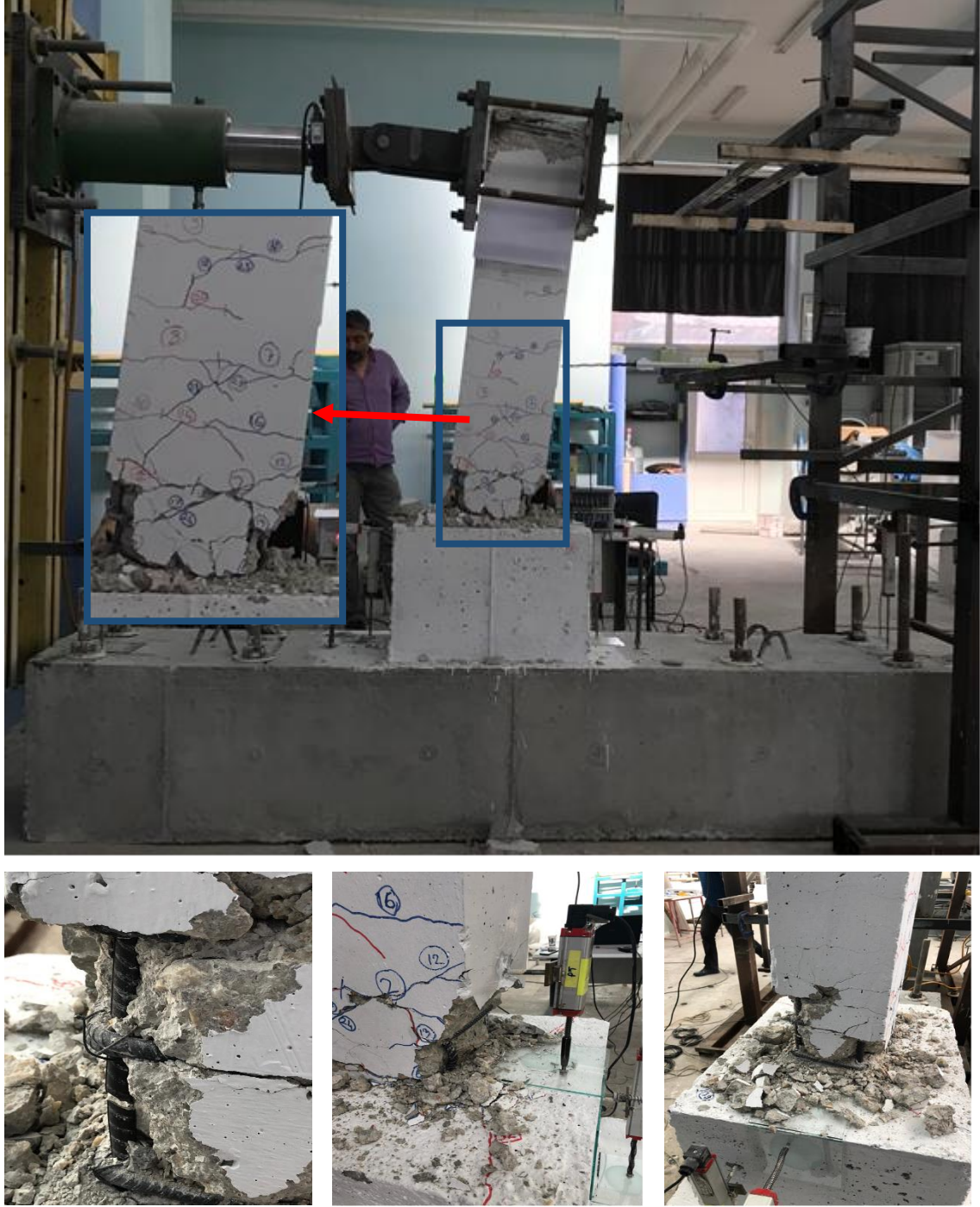
Şekil 4.18. KN2 deney numunesinde limit durum için hasar seviyesi
