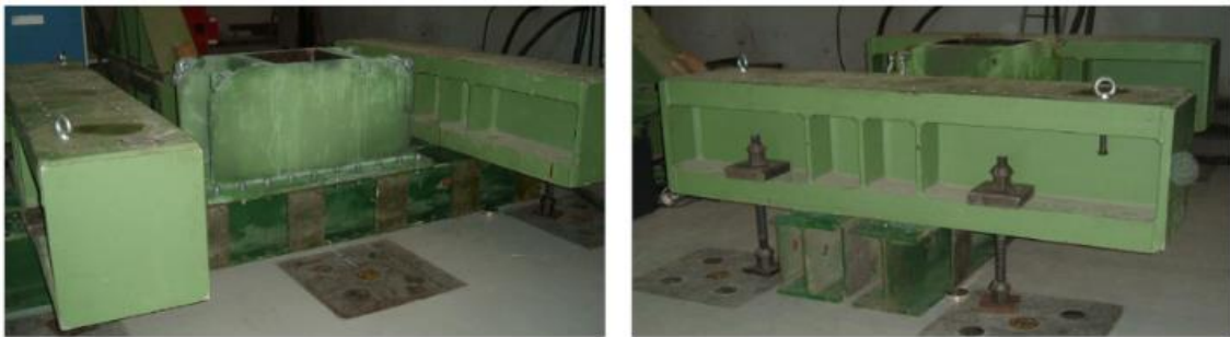
Şekil 2.6. Numunelerin monte edildiği çelik soketler (Germano ve ark., 2015)
