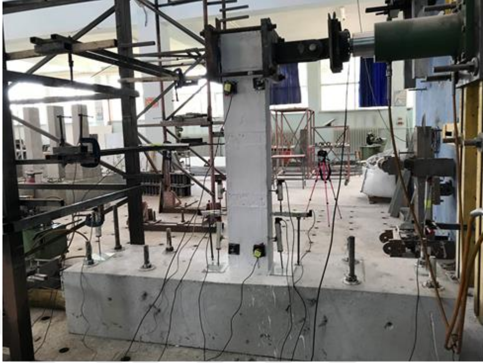
Şekil 3.23. Deney numunesi üzerinde LVDT yerleşimi
