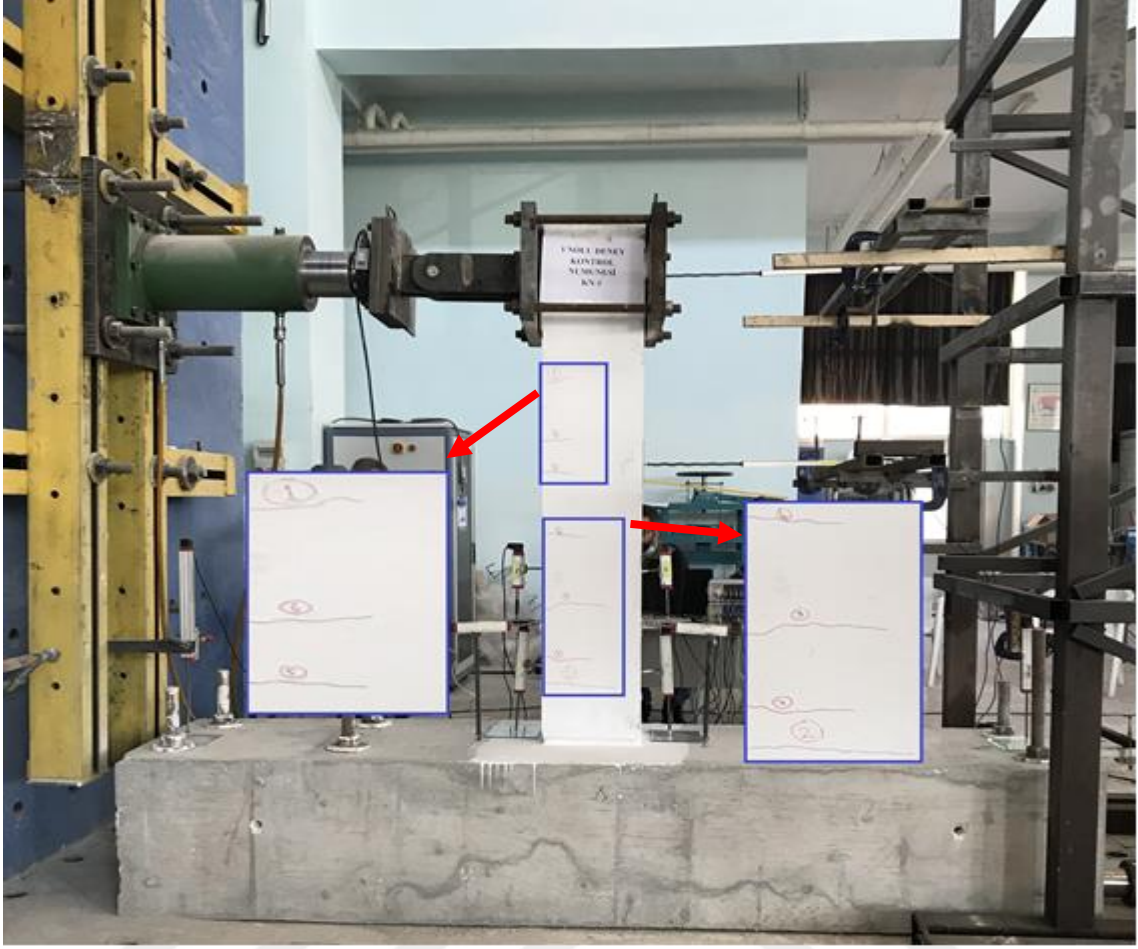
Şekil 4.4. KN1 deney numunesinde ilk hasar oluşumu
