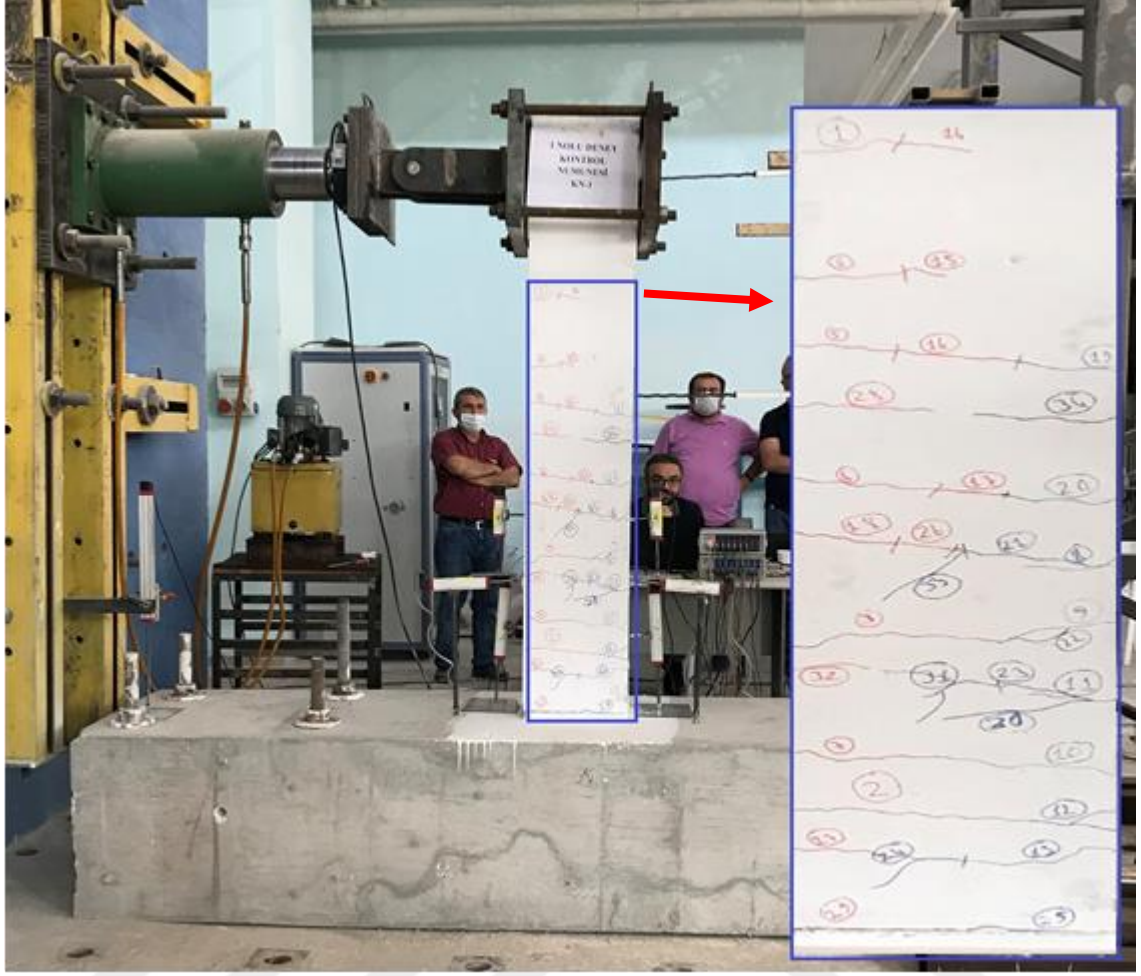
Şekil 4.5. KN1 deney numunesinin akma durumunda hasar seviyesi
