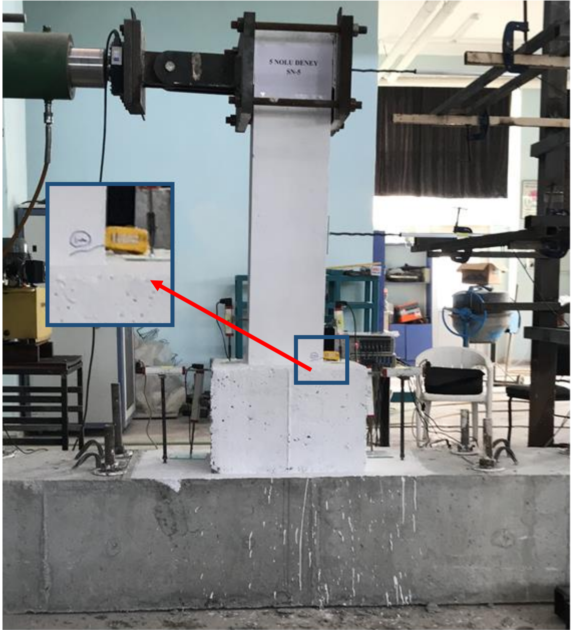
Şekil 4.52. SN5 deney numunesinde ilk hasar oluşumu
