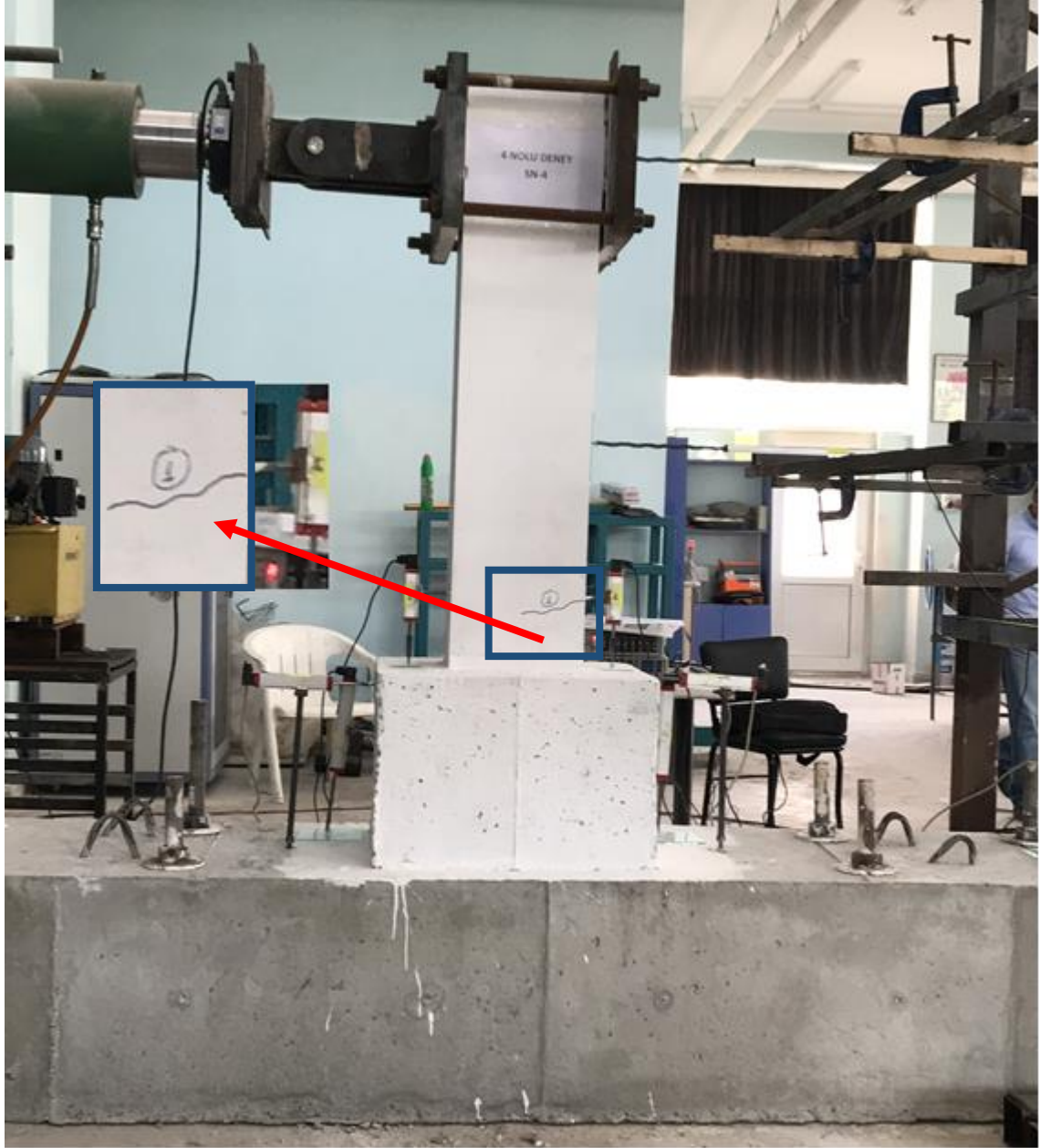
Şekil 4.40. SN4 deney numunesinde ilk hasar oluşumu
