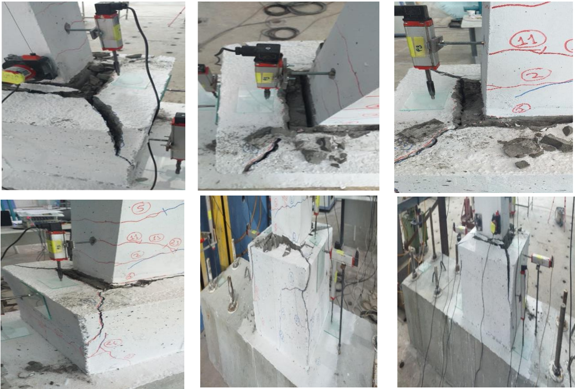
Şekil 4.42. SN4 deney numunesinde limit durum için hasar seviyesi
