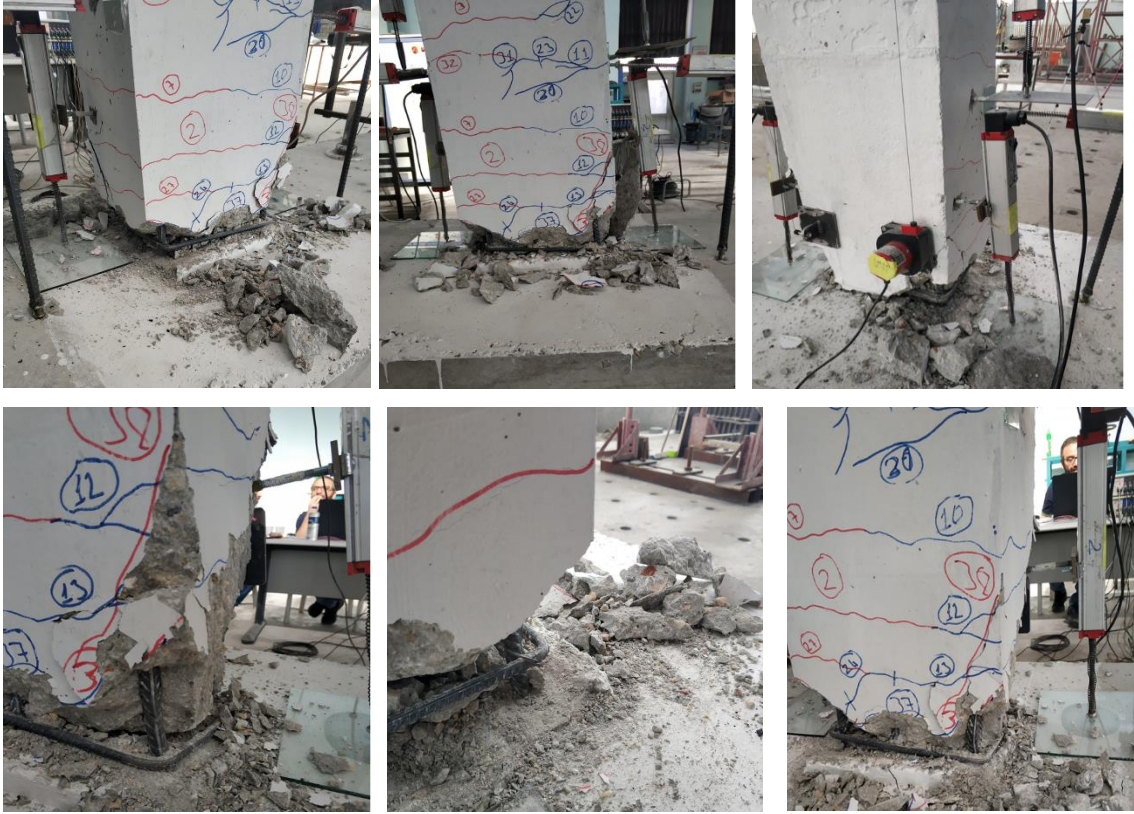
Şekil 4.6. KN1 deney numunesinde limit durum için hasar seviyesi
