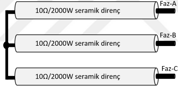
Şekil 38. Üç fazlı direnç yükü bağlantısı
