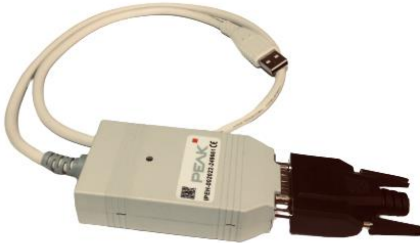
Şekil 67. PCAN USB CAN haberleşme cihazı
