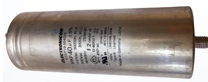
Şekil 37. LC filtre kondansatörü (450V)
