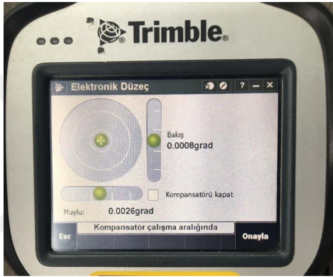
Şekil 3.35 Robotik total istasyonun bağlandığı tripodun düzgünlüğünün kontrol edilmesi
