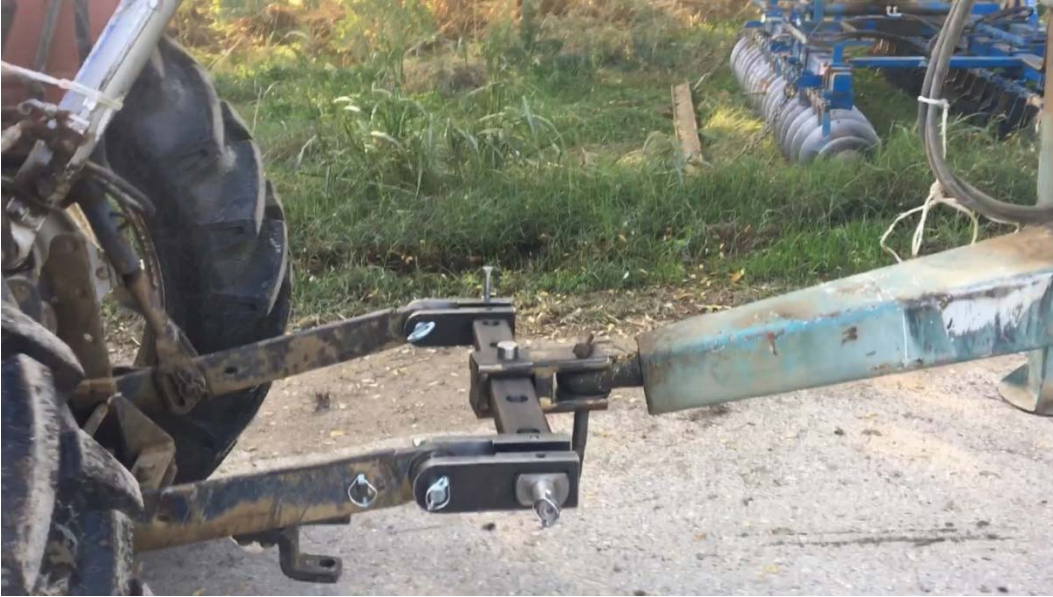
Şekil 3.19 Çeki sisteminin tandem tip tarım römorkuyla ön denemesi
