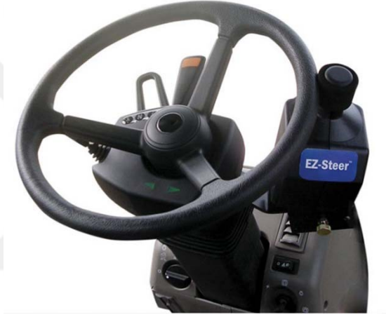
Şekil 1.18 Otomatik dümenleme sisteminde kullanılan, direksiyonla temaslı eyleyici (Trimble, 2021b)
