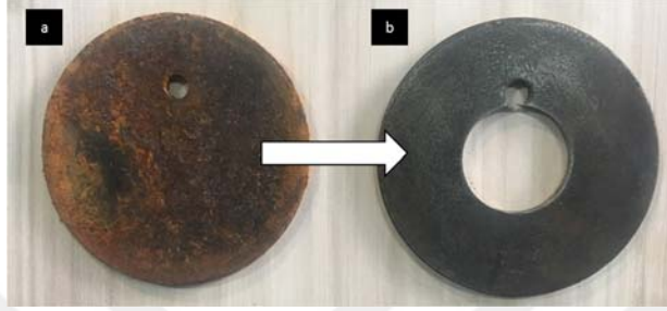
Şekil 3.18 Destek parçası ilk durumu (a), işlenmiş durumu (b)
