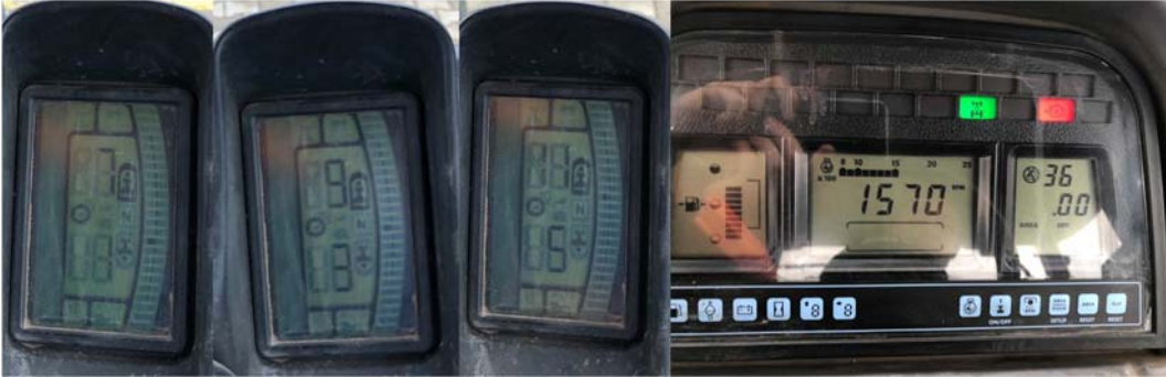
Şekil 3.31 Farklı ilerleme hızlarını sağlayan vites kademeleri, sabit motor devri, üç nokta askı sistemi yüksekliği
