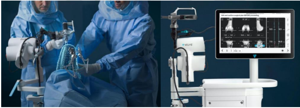
Şekil 2.17 : Diz eklem ameliyatı Robotu Velys – JohnsonveJohnson (Url- 24).
