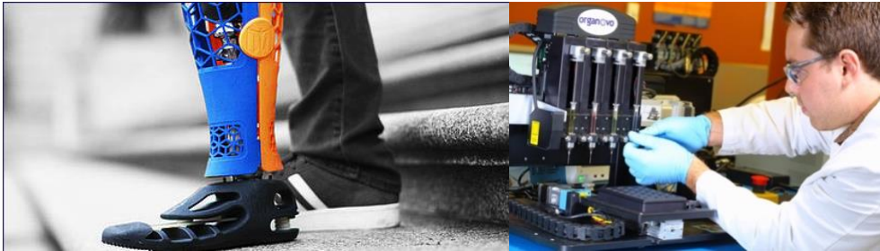
Şekil 2.6 : Resim: 3B baskı yöntemlerinin kullanılması: Kişiye özel protez yapımı, Akciğer dokusu basımı (Url-15).
