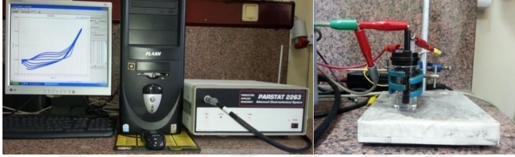
Şekil 3.5 : Elektrokimyasal polimerleşmede kullanılan potansiyostat ve hücre.
