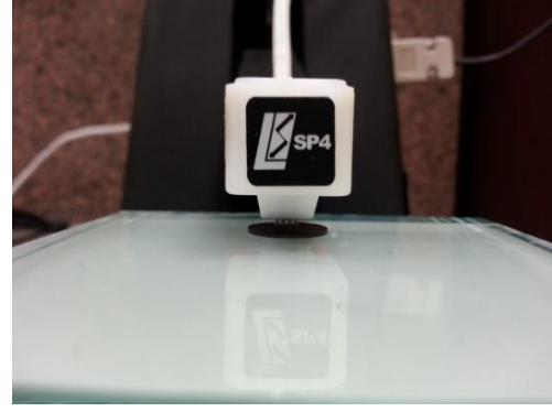
Şekil 3.4 : İletkenlik ölçüm sistemi.
