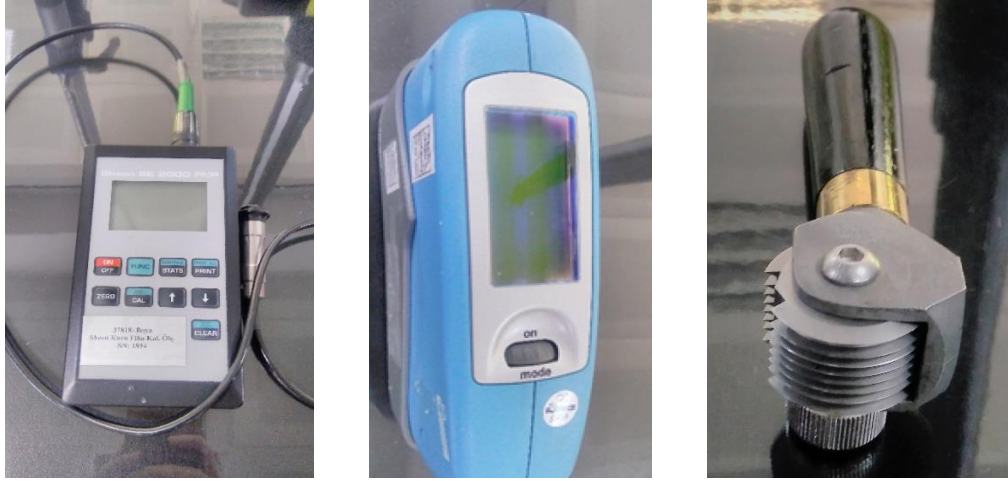
Şekil 3.6 : Kuru film kalınlık ölçer cihazı, glossmetre cihazı ve yapışma test bıçağı.
