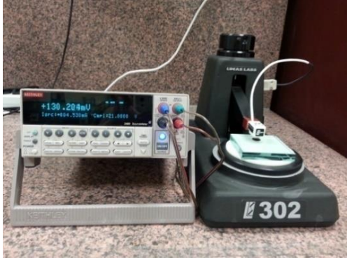
Şekil 3.4 : İletkenlik ölçüm sistemi.
