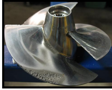
Şekil 3.6. Kavitasyon aşınmasına maruz kalmış bir pervane görseli [171].
