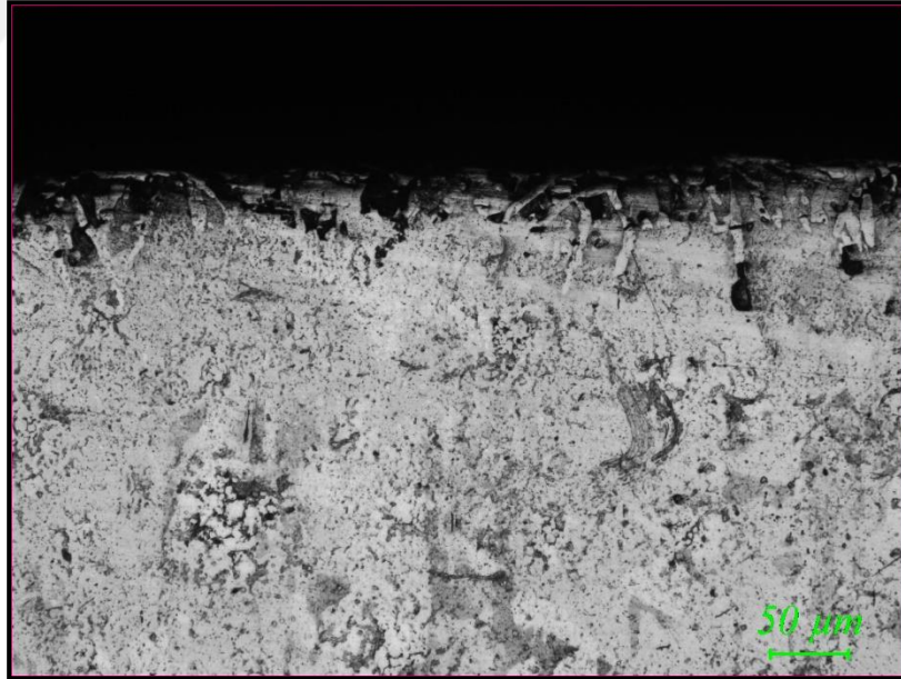
Şekil 5.96. 0M80-6 kodlu numuneye ait mikroyapı görüntüsü (200x).
