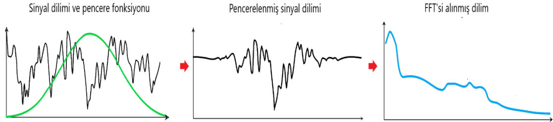
Şekil 4.19. Giriş sinyalinin herhangi bir dilimi için FFT alma işlemi.
